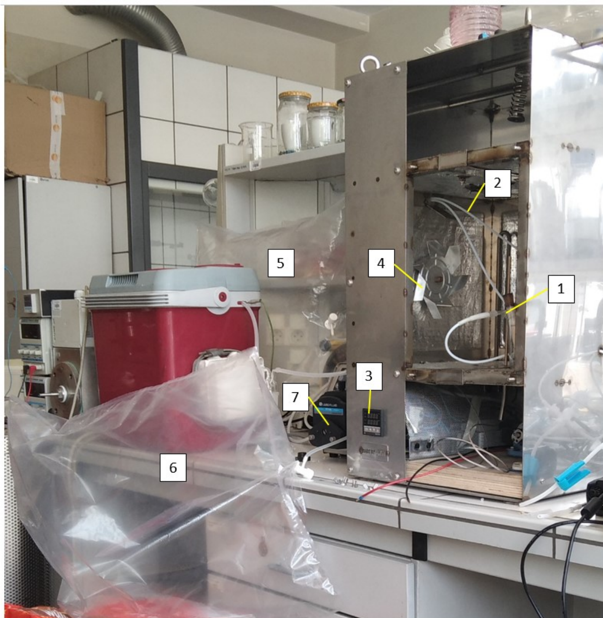
Rys. 3.11. Moduł testowania sorbentów końcowej wersji układu. 1 – u-rurka, 2 – bypass, 3 – regulator temperatury, 4 – wentylator, 5 – źródło azotu, 6 – źródło CO 2 , 7 – pompa perystaltyczna.
