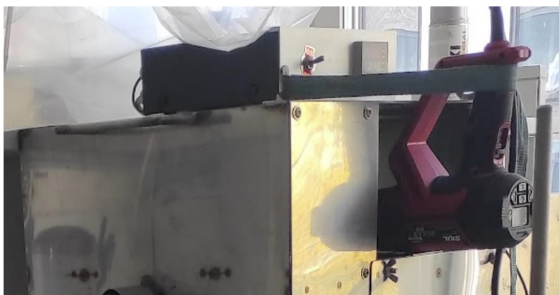
Rys. 3.5. Dodany do modułu wibracyjnego ogrzewacz o mocy 2000 W.
